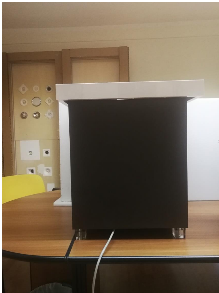
Foto 2. Sanificatore d'aria "Air Sterilization a led UV-A da 365 nm da 16 mc/h",
